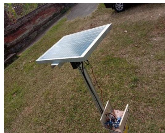
Alat pengusir burung otomatis ini menggunakan program arduino. Rangkaian alat dan bahan ini meliputi : *solar cell*, rangka baja bekas, stavolt bekas, dinamo serta *accu* dengan kekuatan 12 volt sebagai sumber tenaga yang digunakan untuk memutar/menggerakan alat yang dapat menimbulkan bunyi.
